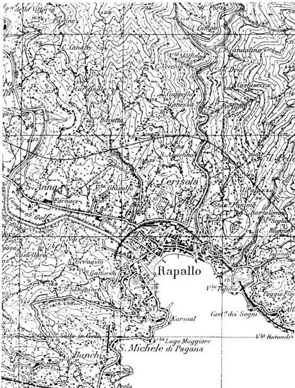
Fig. 12 – Progetto preliminare di un'autostrada su cartografia, alla scala 1:25.000 (il progetto di massima, alla scala 1:10.000, è mostrato in fig. 13, ed il progetto esecutivo, alla scala 1:2.000, è mostrato in fig. 14)
