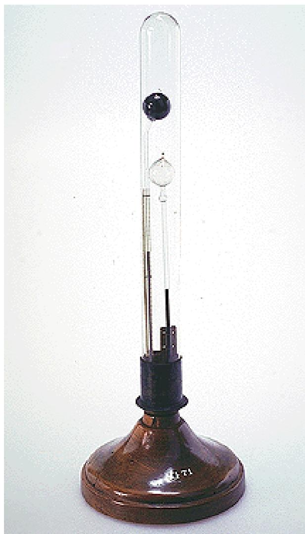
Fig. 8 – Lucimetro di Leslie (Gabinetto di Fisica di Volta – Università di Pavia)
